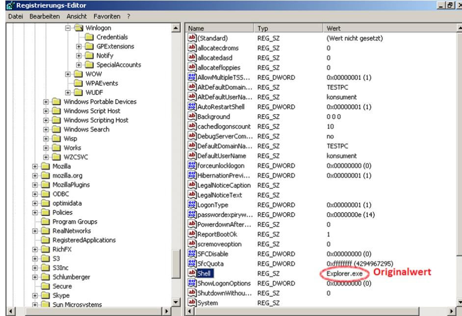
Durch einen Doppelklick auf **Shell** öffnet sich ein Fenster, wo der Pfad zum Virus gelöscht und durch **Explorer.exe** ersetzt wird. Danach auf **[OK]** klicken und das Registry-Fenster schließen **[x]**.
